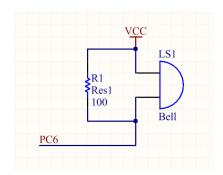
分析: PC6 外面经过上拉电阻 R1,即系统上电,外面给予 PC6 电平为高,如果 makecode.ini 中 SYS\_SWD\_IO\_PU\_EN 配置为下拉的情况下,且 PA3、PC7 都为高电平,就会进入超级模式,而且当配置为下拉,蜂鸣器也会响,所以为了避免这种情况,必须将 makecode.ini 中 SYS\_SWD\_IO\_PU\_EN 配置为上拉。
