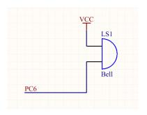
分析:如果 SYS\_SWD\_IO\_PU\_EN 配置成下拉,蜂鸣器上电会处于导通状态,所以应该把 SYS SWD IO PU EN 配成上拉。
