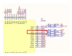
根据上图方案板中只有 KEY7 没有复用 SEG 口,且 KEY7 对应的 PA3,所以只需要将 PA 配置为输出模式并输出低电平即可。如下述:
