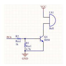
分析: PC6 外面经过 R2 和 R1 连接到地,所以为低电平,因此 makecode.ini 中 SYS\_SWD\_IO\_PU\_EN 配置为上拉的情况下,且 PA3、PC7 都为高电平,就会进入超级模式,所以为了避免这种情况,必须将 makecode.ini 中 SYS\_SWD\_IO\_PU\_EN 配置为下拉。
